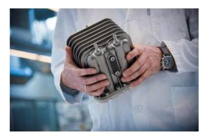
Overall:  $Heat(T\Delta S) + electricity(\Delta G) + H_2O \rightarrow H_2 + \frac{1}{2}O_2$ HALDOR TOPSOE
